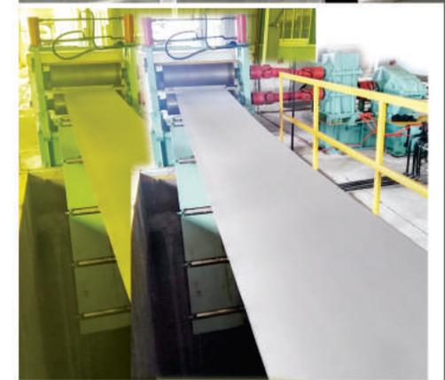
Dây chuyền tẩy rửa liên tục sản xuất, công dụng chủ yếu là để tẩy rửa lớp oxy hóa sắt, rỉ sét trên bề mặt nguyên liệu thép, nhằm đảm bảo chất lượng sản phẩm mạ kẽm, mạ màu tiếp đó.
