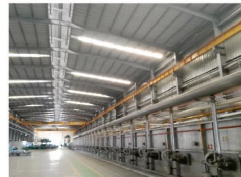
Dây chuyền mạ kẽm nhúng nóng liên tục là thép cuộn đưa vào dây chuyền, hàn nối lại, tẩy rửa bề mặt và qua xử lý nhiệt, sau đó đi vào màng kẽm, tiếp đến đi qua máy cân chỉnh phẳng và trực lực căng, sau cùng tùy theo yêu cầu khác nhau tiến hành xử lý bôi dầu.
